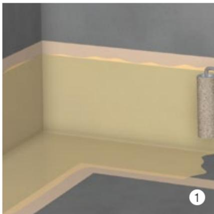
Untergrundvorbereitung gem. S. 9–11 Abdichtungsfläche abkleben. Passende Grundierung (gem. UG-Tabelle S. 12–16) mittels Roller oder Pinsel auftragen.
