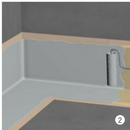
Einbettschicht mit BIKUCOAT-SMP ECO auftragen ( $\sim 2,0 \text{ kg/m}^2$ ).
